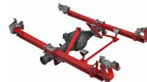
La suspensión trasera mejorada que cuenta con una ballesta auxiliar nueva y los amortiguadores modernos Mando aseguran una estabilidad elevada en los caminos y la suavidad de funcionamiento del bloque con la carga total del vehículo.
