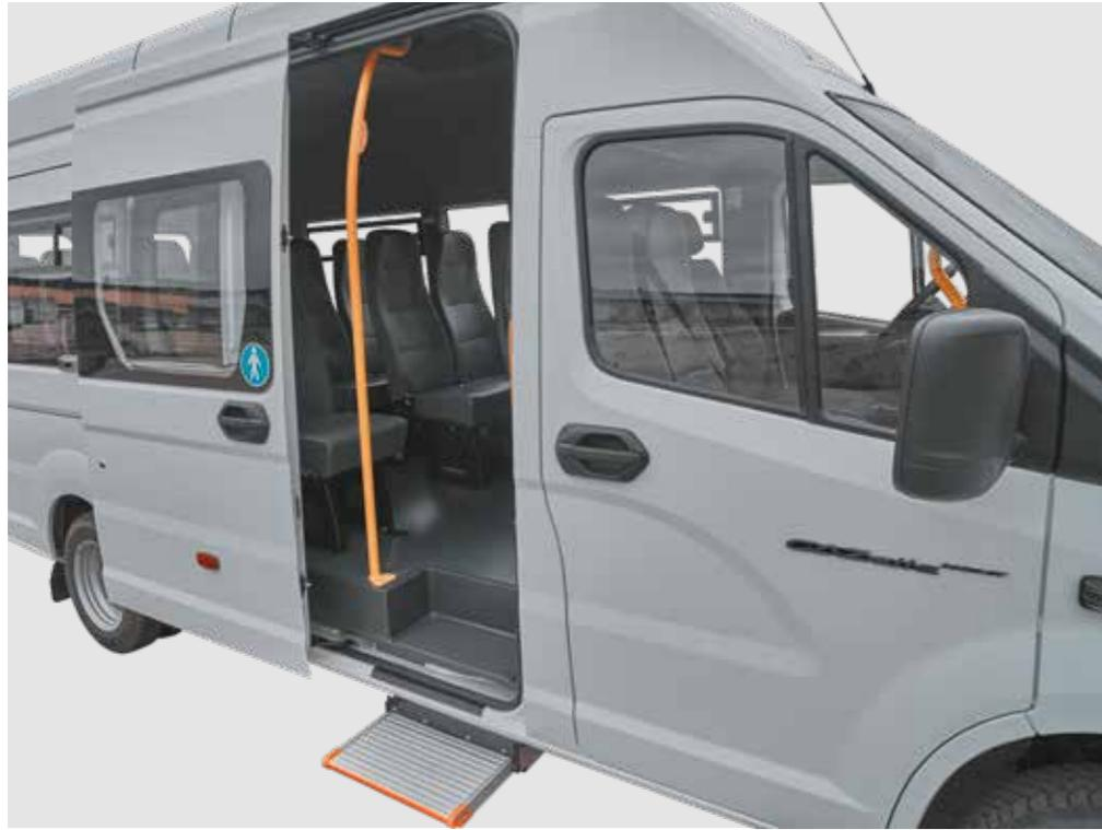
El habitáculo tiene previsto un vano de la puerta lateral alto y un estribo bajo con accionamiento eléctrico, lo que permite a los pasajeros subir y bajar con mayor comodidad. El estribo sale de modo automático con la apertura de la puerta lateral corredera, se mete dentro tras su cierre.
