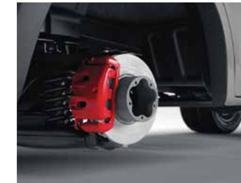
El sistema de frenos de doble circuito con la superficie aumentada de las almohadillas de frenos tiene el margen de seguridad tres veces más alto. El vehículo puede disponer de un bloqueo forzado del eje trasero, lo que aumenta la capacidad de paso por camino resbaladizo, arenas o en barro.
