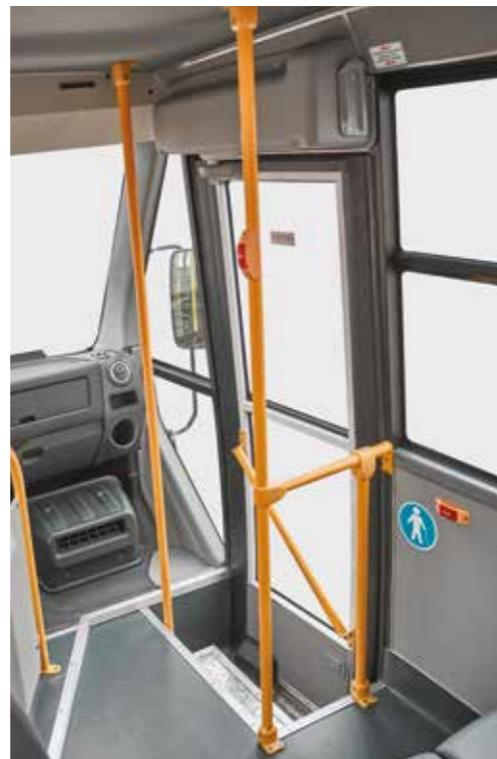
La puerta giratoria con el accionamiento electromecánico, controlada por el conductor, y el estribo bajo permiten subir y bajar con más comodidad.
