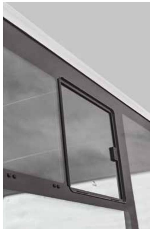
La ventilación del habitáculo se realiza de modo natural a través de las ventanillas correderas y las escotillas en el techo. Se ofrece la opción de instalar el sistema de aire acondicionado en el habitáculo.
